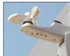
Bei vorhandenem Steuerungssystem sollte der mechanische Windsensor periodisch auf Beschädigungen durch externe Einflüsse bzw. auf seine Funktionstüchtigkeit überprüft werden (Drehverhalten bei Wind beobachten). Sollte sich der Windsensor nicht richtig drehen, muss er von einem KLAIBER Fachhändler überprüft werden.
