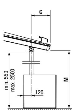
C = mind. 300 mm mit automatischer Arretierung (io) Maticlock
