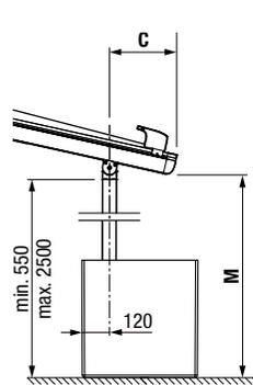
C = mind. 270 mm mit automatischer Arretierung (io) Maticlock
