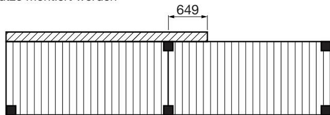
Bei Wand- / Deckenanschluss **ab 650 mm** überstand muss keine Stütze montiert werden
