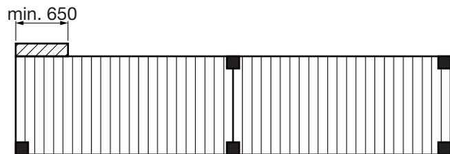
Bei Wand- / Deckenanschluss **bis 649 mm** überstand muss zwingend eine Stütze montiert werden
