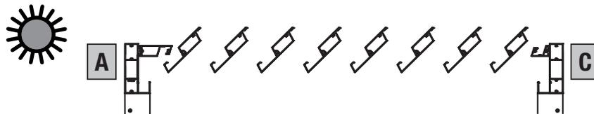
Lamellen maximal geöffnet (115 Grad)
