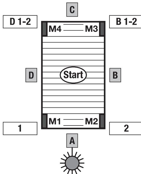
Die Motorenposition muss für alle weiteren Module dieselbe sein.
