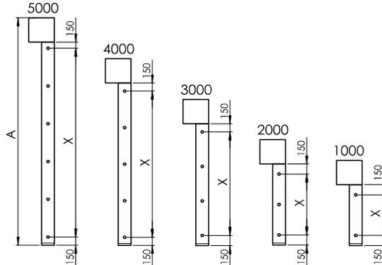
Die restlichen Befestigungspunkte werden gleichmäßig verteilt.
