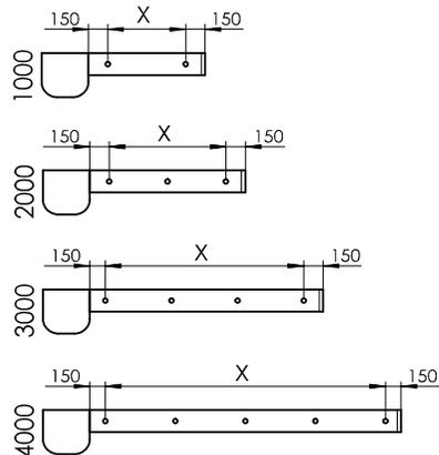
Die restlichen Befestigungspunkte werden gleichmäßig verteilt.
